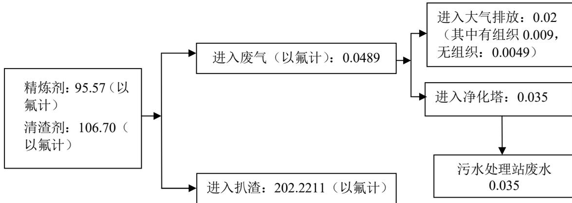
图2.4-13 拟建项目熔炼过程中氟平衡（单位：t/a）
